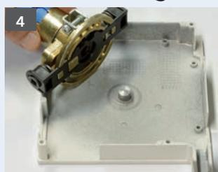
Kegelradgetriebe mit Schnellmontagesystem und Klemmblech auf den gekürzten Zapfen aufsetzen.
