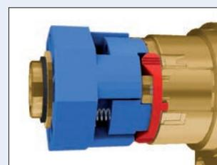
... und Rohrmittnehmer ebenfalls nach links drehen bis die Auflaufkupplung einrastet.
