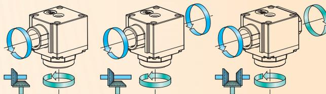
Umlenkgetriebe mit einem Antrieb und einem Abtrieb.
