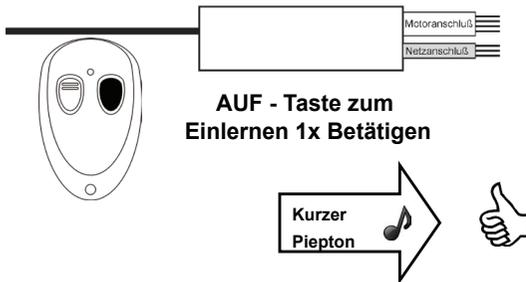
Die ZU - Taste (Gegenrichtung) wird automatisch mit eingelernt!
