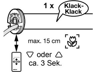
3. Halten Sie den Handsender an das Netzkabel und betätigen Sie die AUF- (△) oder AB-Taste (▽) für 1 Sek. Der Motor bestätigt (1 x „Klack-Klack“).
