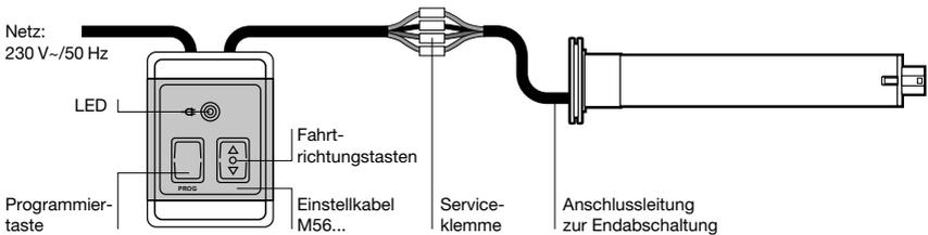
Einstellkabel an die Anschlussleitung des Motors anschließen (siehe Anschlussbild auf der Rückseite des Einstellschalters). Die Zuordnung zur Drehrichtung ist von der Einbausituation des Antriebs abhängig. Dann den Einstellschalter mit dem 230V-Netz verbinden.
