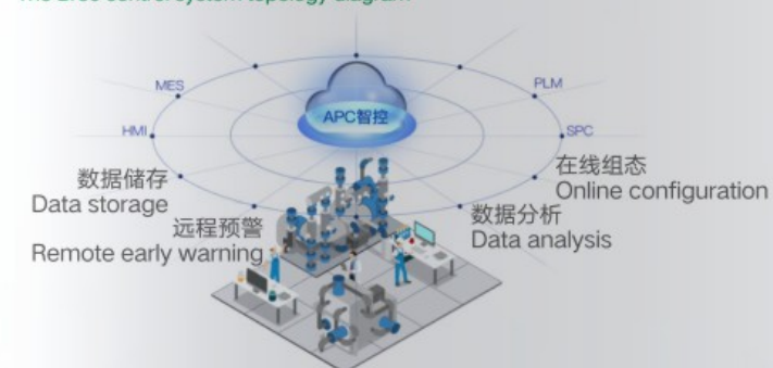
Brec控制系统拓扑图
