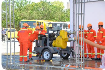
移动泵送系统无法完成积水强排的前提下，增派排涝机器人，加快排水速率。排涝机器人全称为“XWR800T 轮式排涝机器人”，配置大排量高效自吸水泵，额定流量800m<sup>3</sup>/h，额定扬程15m，自带8.5米吸程，适用于下立交地道等狭小地域的应急排涝救援。
