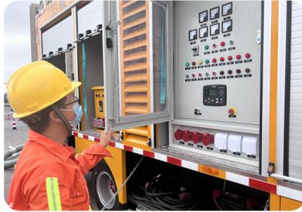
水泵的概念，设备可满足紧急排水抢险的需要，紧急排水量可达到500-2000 m<sup>3</sup> / 小时。具备移动电源功能，可帮助其他设备供电，移动发电每小时可达到100KW-500KW。车厢配备液压支腿，保证施工作业时整车稳定性；车厢内部装配不同尺寸和间距的工具架，用于存放和运输不同功能
