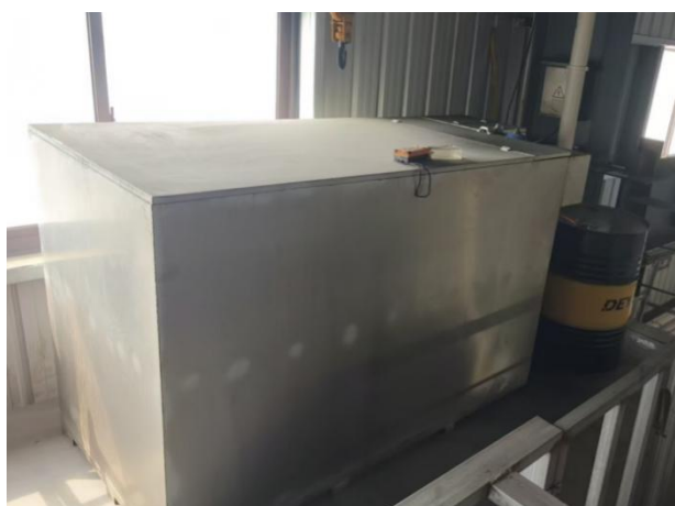
切削液过滤回收系统
