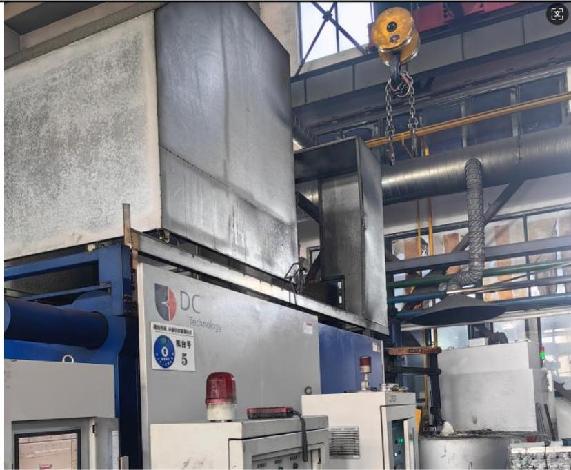
压铸机、熔化保温炉集气罩及集气管道
