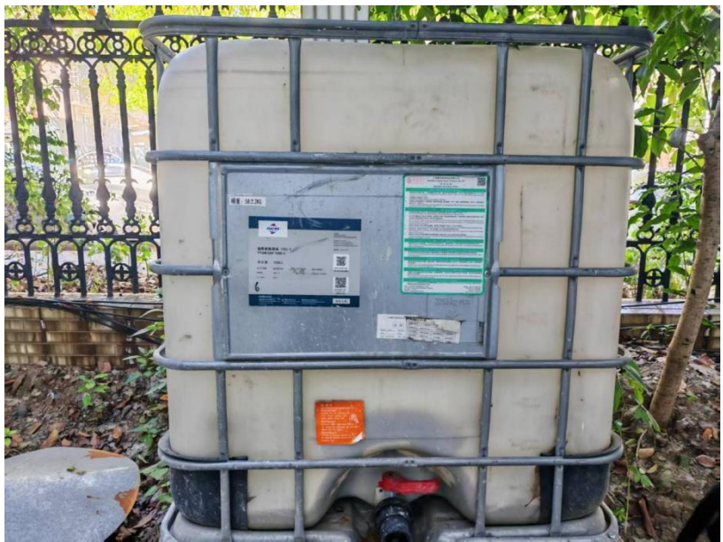
图3-2 研磨废水暂存桶
