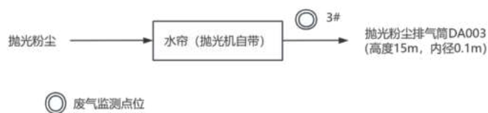
图 3-5 抛光粉尘治理工艺流程图
