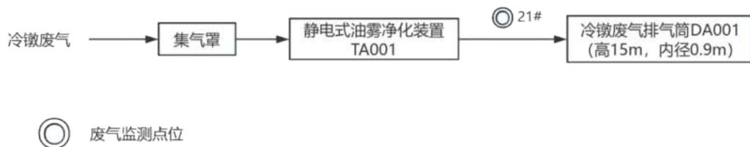
图 3-1 冷镦废气治理工艺流程图
