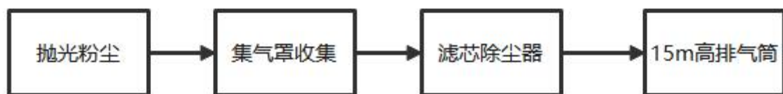
图 3-5 抛光粉尘治理工艺流程图
