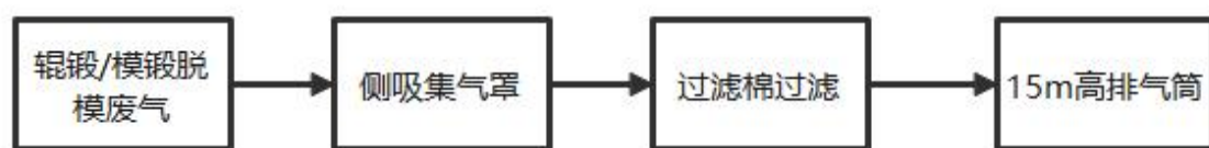
图 3-1 辊锻/模锻脱模废气治理工艺流程图
