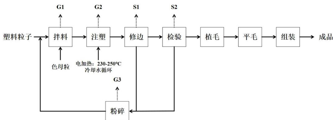
图 2-1 塑料扫帚、部分洁具(如刷子)生产工艺流程及产污环节图
