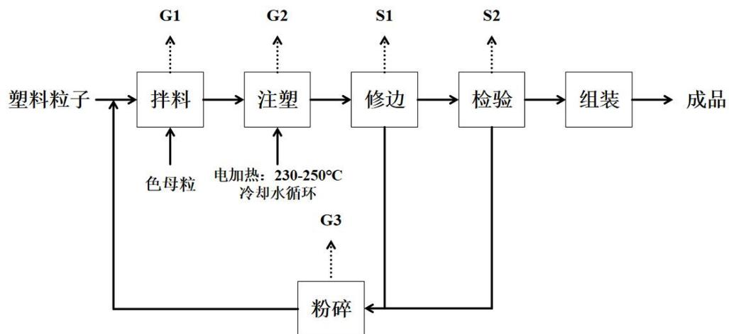
图 2-2 拖把、洁具生产工艺流程及产污环节图
