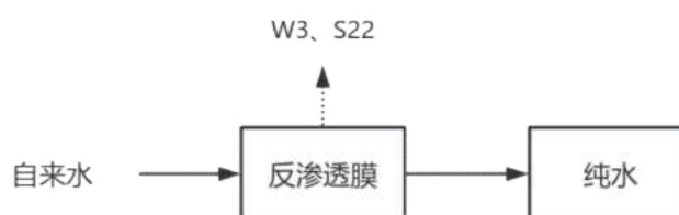
图 2-5 纯水制备工艺流程及产污节点图
