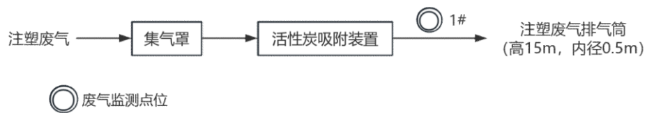
图 3.1 注塑废气治理工艺流程图
