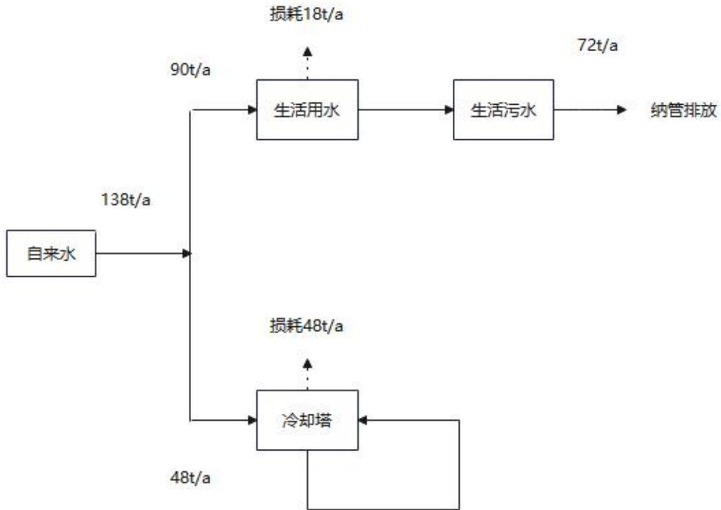
图 2-1 项目实际水平衡分析图
