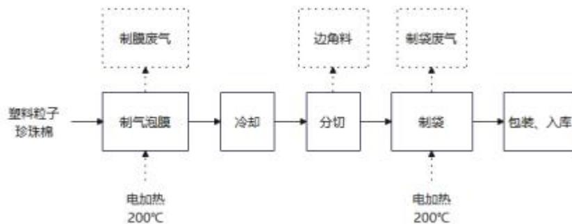
图 2-2 气泡袋、珍珠棉袋生产工艺流程及产污环节图
