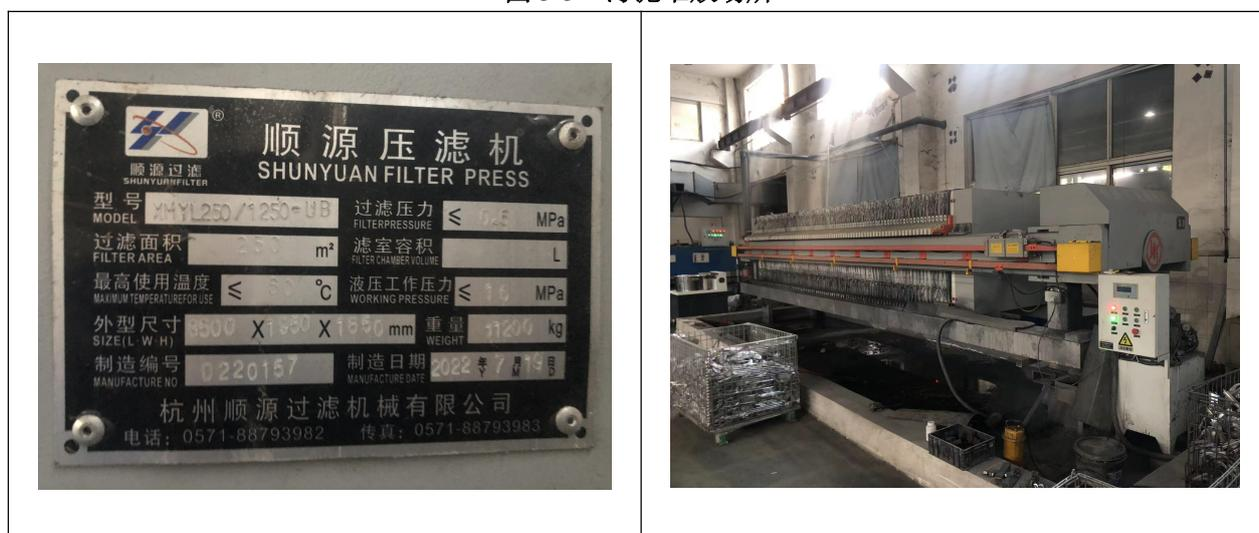
图 3-4 板框压滤机设备图
