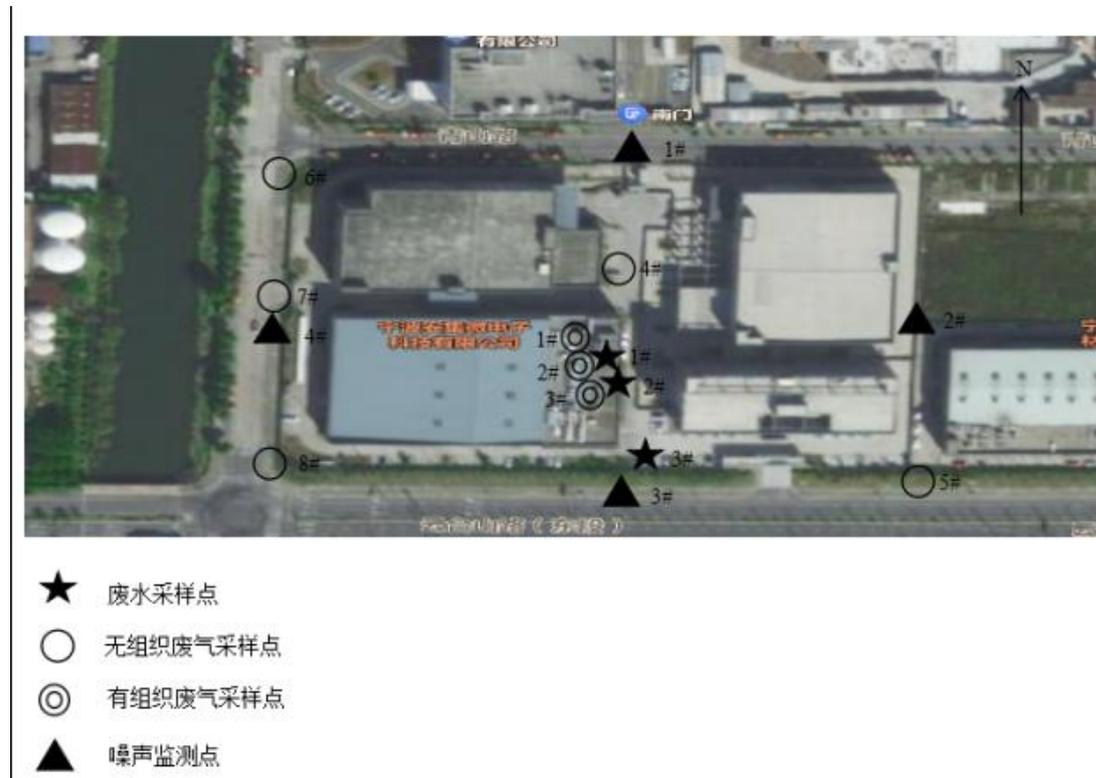
图 7-1 有组织、无组织废气及厂界噪声检测布点图
