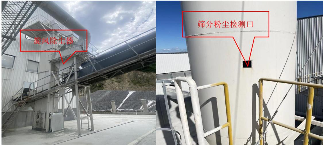
图 3-6 筛分粉尘废气治理照片
