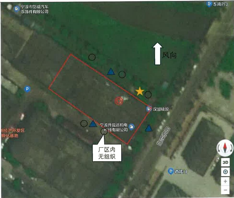
▲ 噪声检测点   ★ 废水采样点   ○ 无组织采样点   ⊙ 有组织采样点
