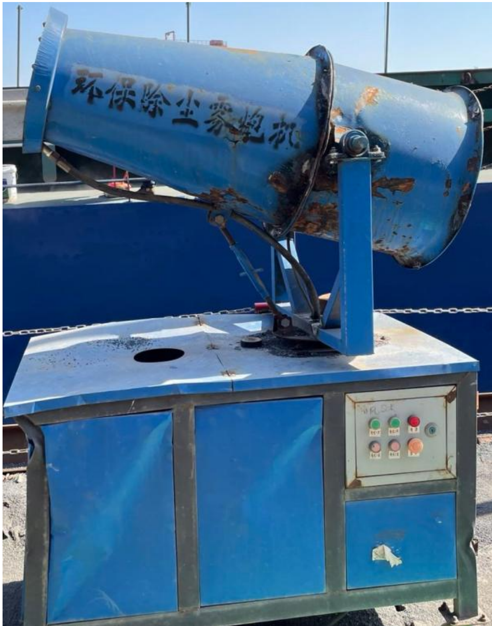
图4-3 环保除尘雾炮车
