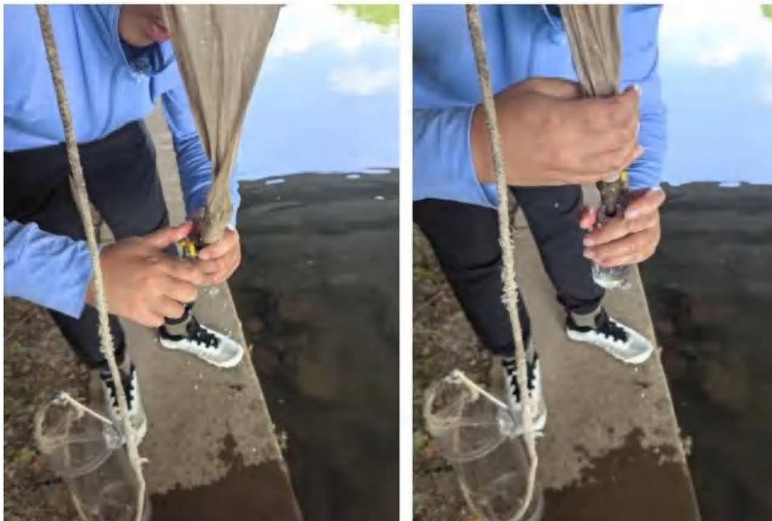
浮游动物定性采集:原生动物、轮虫一类小型浮游动物用 25 号筛绢浮游生物网(孔径 0.064mm),大型浮游动物枝角类和桡足类用 13 号筛绢浮游生物网(孔径 0.115mm)。采集时,在表层至 0.5m 深处以 20~30cm/s 的速度作缓慢拖动约 1~3min,然后过滤至 20mL,放入标本瓶中,现场加 10%福尔马林固定。
