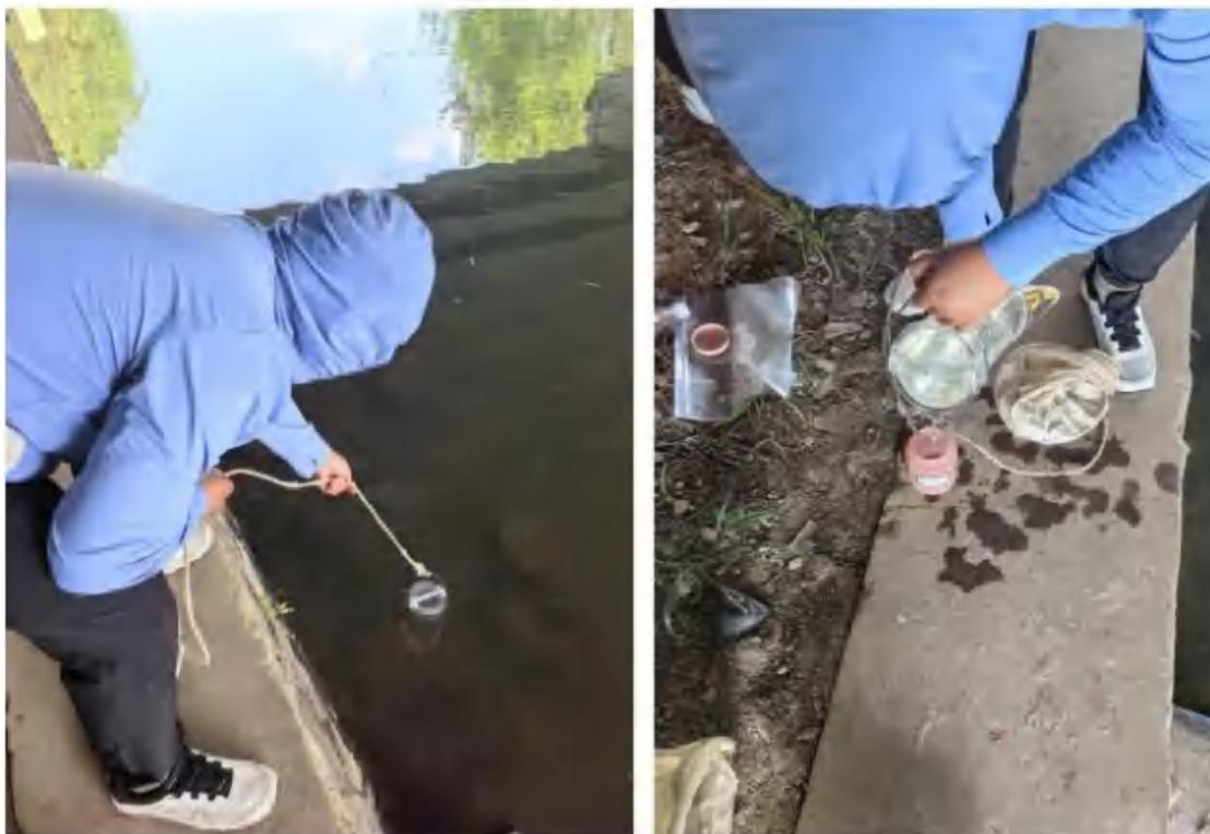
浮游植物定性采集用 25 号浮游生物网在水面以下呈“∞”来回拖行, 将所采集的水样保存于 50mL 小方瓶中, 添加 3-5mL 甲醛溶液保存。
