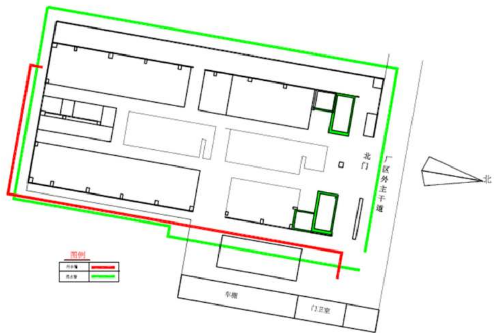
宁波市北仑区霞浦航盛模具塑胶厂-给排水总平面图 1:1000
