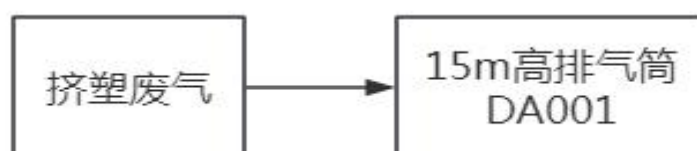
图 3-1 挤塑废气治理工艺流程图
