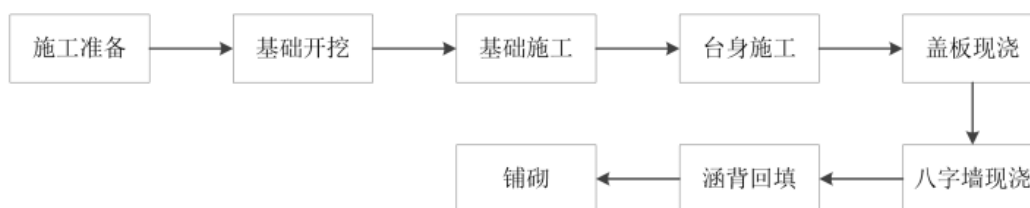
图 4-6 盖板涵施工工艺流程图
