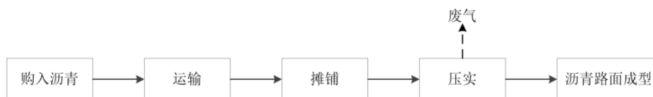
图 4-4 沥青摊铺施工工艺流程图
