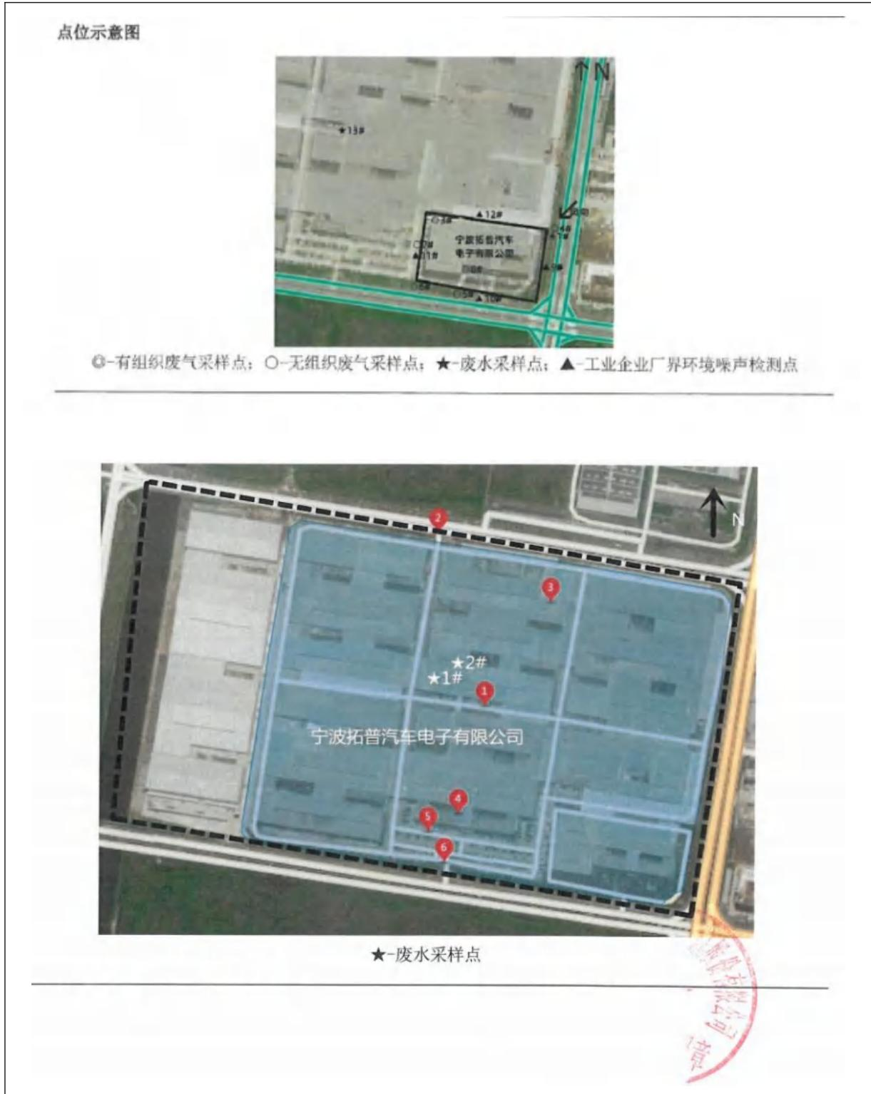
图 6-1 有组织废气、无组织废气、废水及噪声监测点位图
