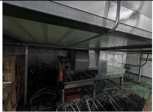
液化石油气循环燃烧装置（烘道拐角处）
