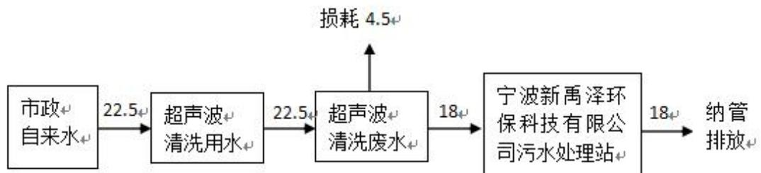
图 2-1 本项目实际水平衡分析图
