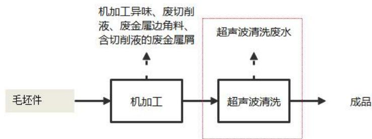
图 2-2 工程机械配件及其他零部件工艺流程及产污环节图
