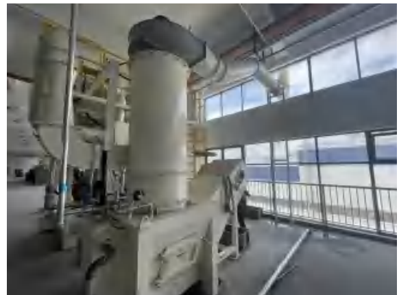
图 3-6 抛丸粉尘治理设施照片
