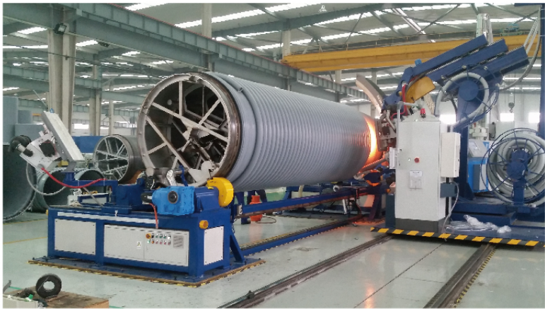
PP缠绕结构壁管道 生产制造中（中国）
