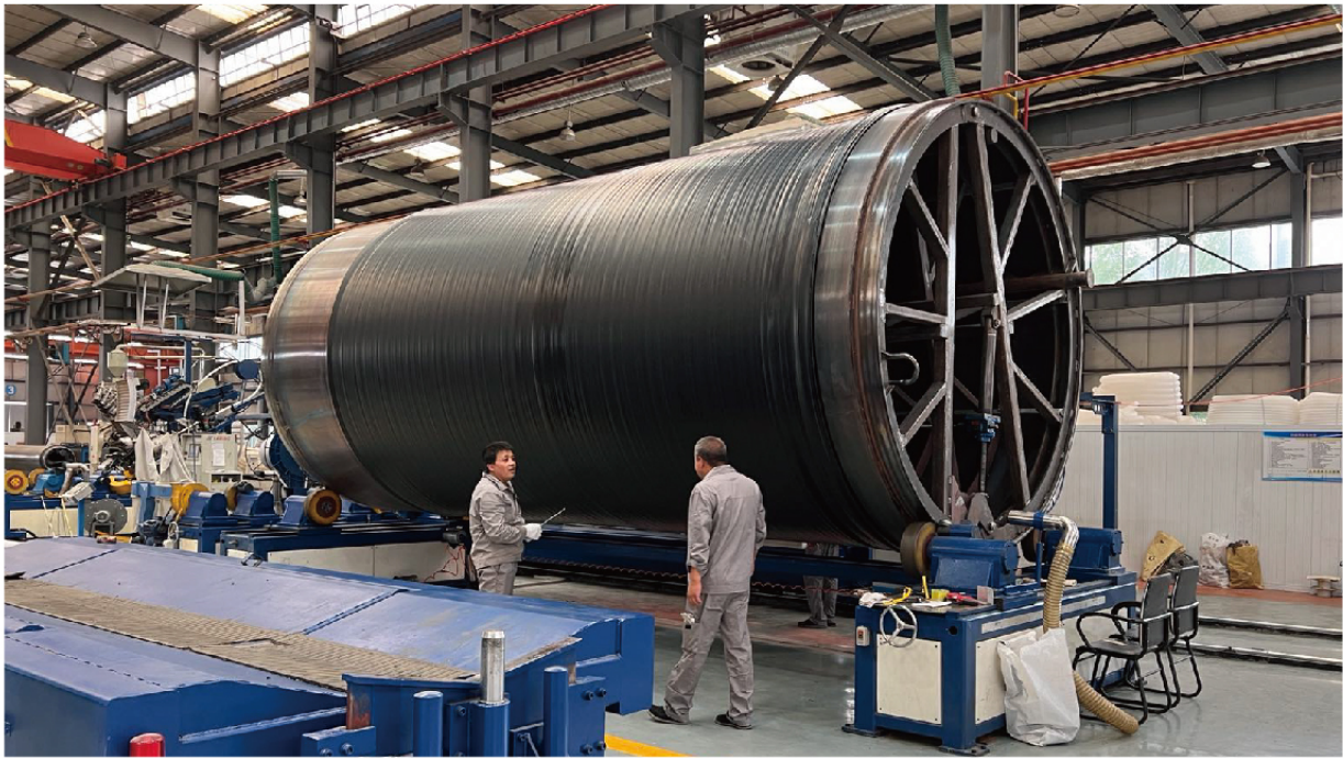
DN3000 HDPE缠绕结构壁管道 生产制造中（中国）
