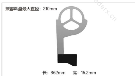
NXT 8mm后上方挂料支架尺寸图
